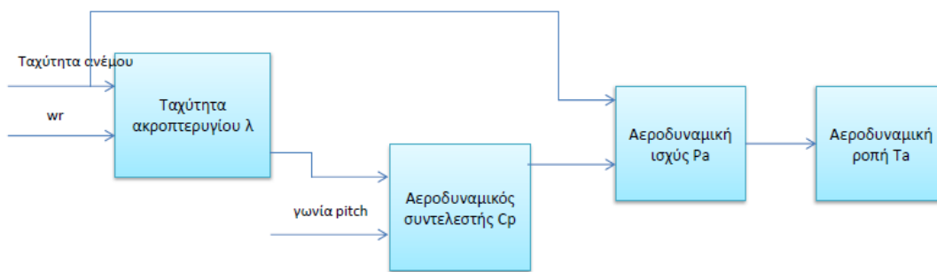
Σχήμα 2.2.1.1 Μοντελοποίηση αεροδυναμικού μέρους
