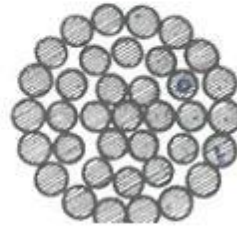
Σχήμα 3-1: Γυμνοί πολύκλωνοι αγωγοί αποτελούμενοι από 7, 19 και 37 κλώνους
