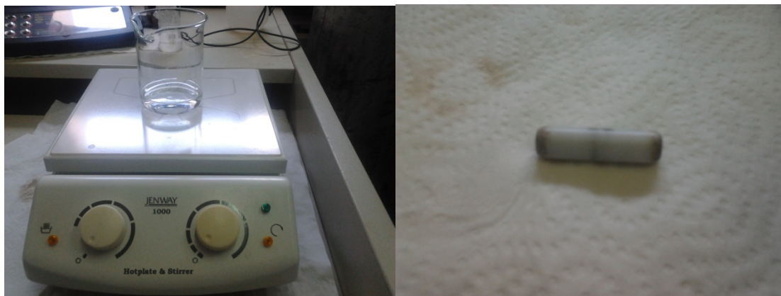
Σχήμα 6.8: Μαγνητικός αναδευτήρας και ο μαγνήτης
