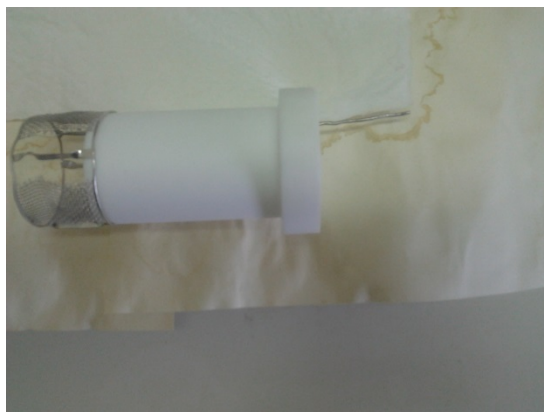
Σχήμα 6.3: Το βοηθητικό ηλεκτρόδιο και εσωτερικά του πλέγματος είναι το ηλεκτρόδιο εργασίας
