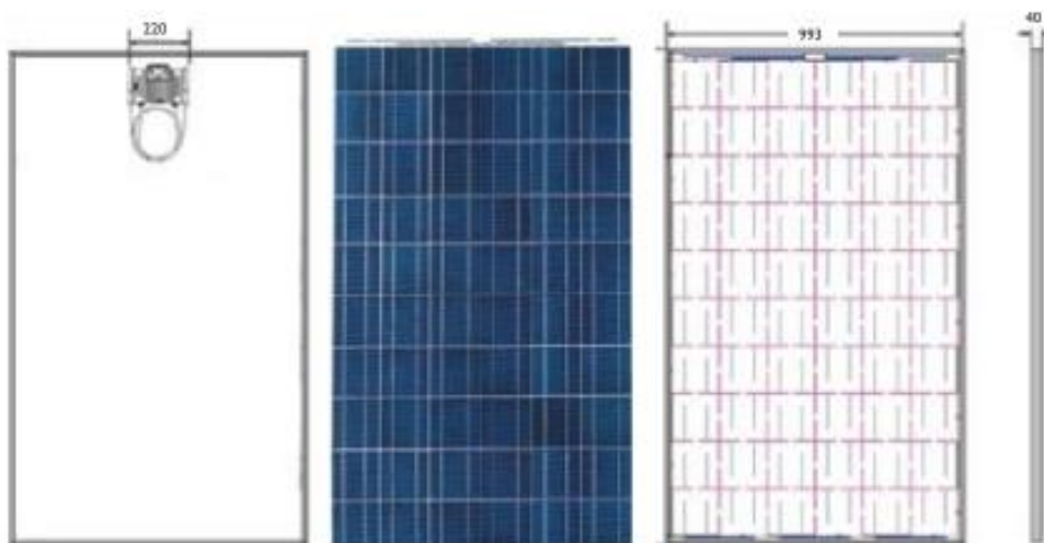
Σχήμα 7.10 Εμπρόσθια και οπίσθια όψη του πλαισίου SE 220 μαζί με τις διαστάσεις του.
