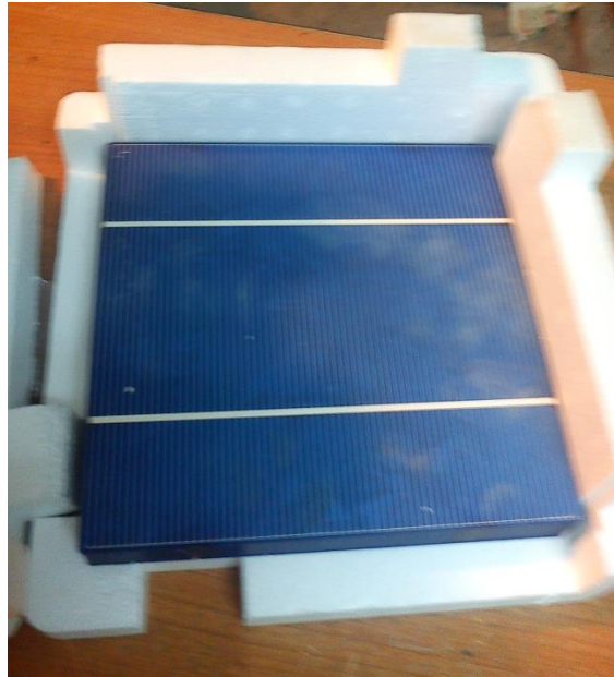
Σχήμα 8.1 Φωτογραφία από τις 60 πολυκρυσταλλικές κυψέλες πριν την κατασκευή του πλαισίου.
