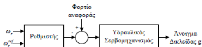
Σχήμα 2-3: Σχηματικό διάγραμμα μηχανικού – υδραυλικού ρυθμιστή στροφών αμοστροβίλου [46]
