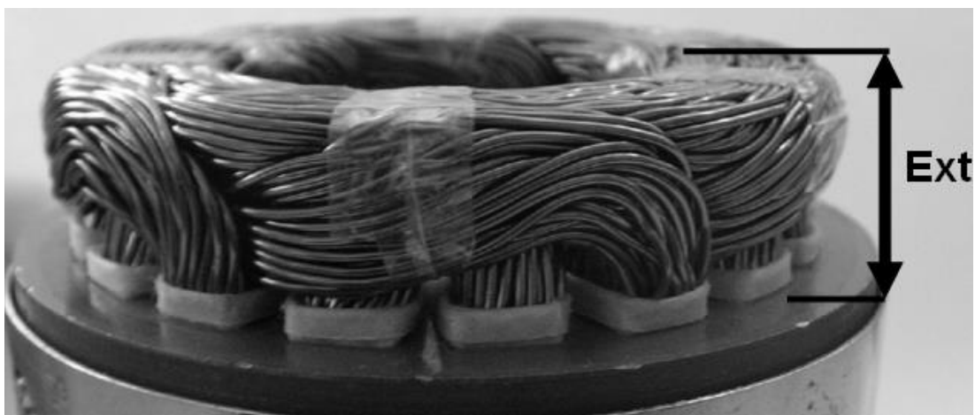
Σχήμα 3.12: Άκρα διανεμημένου τυλίγματος [25].
