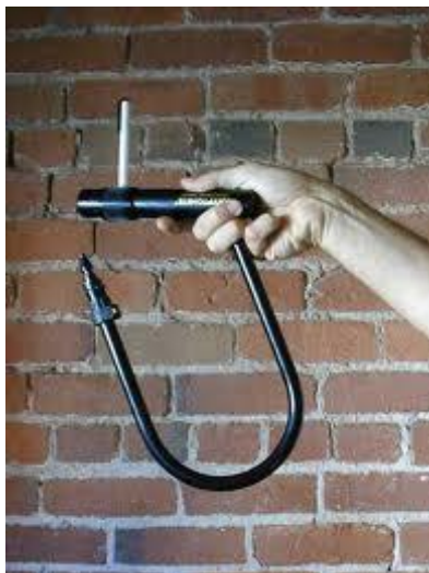
Εικόνα 16: Η κλειδαριές Kryptonite ανοίγουν με ένα στυλό Bic σύμφωνα με τα βίντεο και τις αναρτήσεις που έκαναν τον γύρο των social media [υ]
