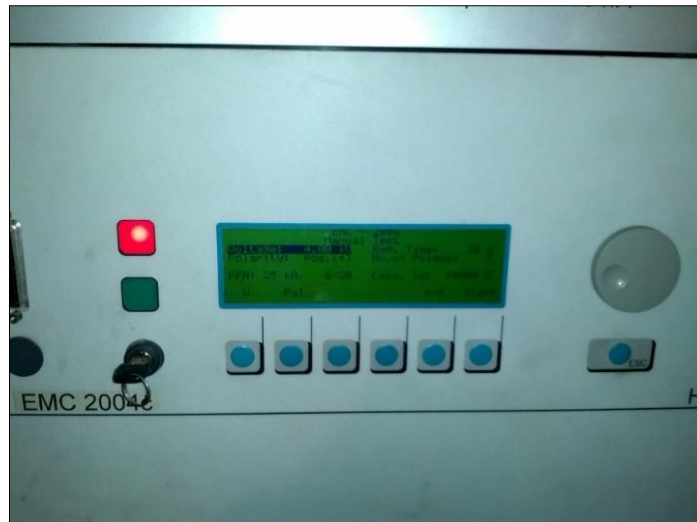
Εικόνα 4.4: Ρύθμιση τάσης φόρτισης της γεννήτριας υπό τάση
