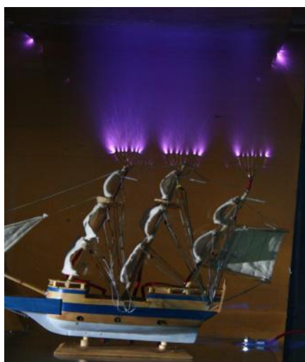
Εικόνα 3.3: Το φαινόμενο της "Φωτιάς του St. Elmo" σε μοντέλο πλοίου [22]
