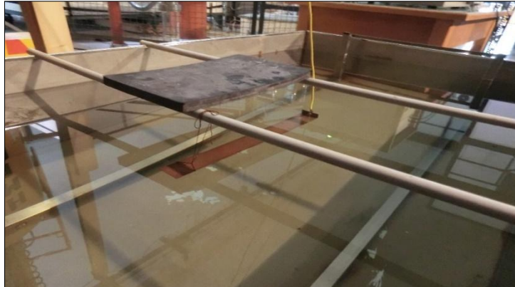
Εικόνα 4.11: Μηχανισμός στήριξης ηλεκτροδίου μέσα στη δεξαμενή
