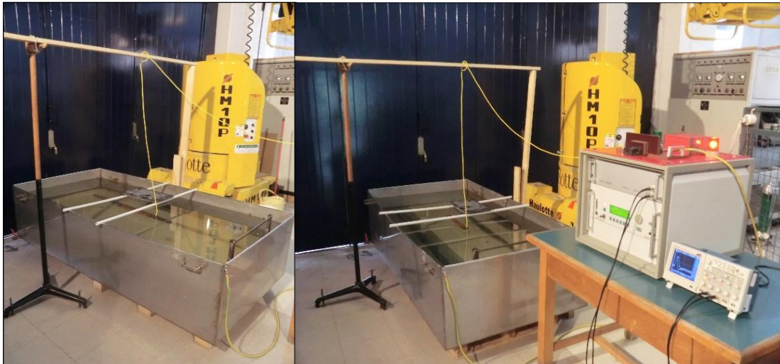
Εικόνες 4.12-4.13: Μηχανισμός στήριξης του καλωδίου τροφοδότησης και συνολική εικόνα της διάταξης
