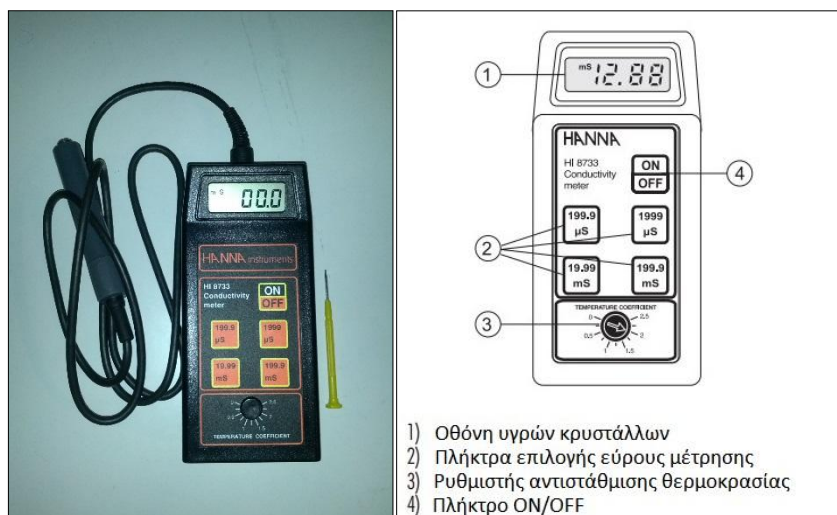
Εικόνα 4.6: Αγωγιμόμετρο HANNA Instruments 8733 και λειτουργική περιγραφή
