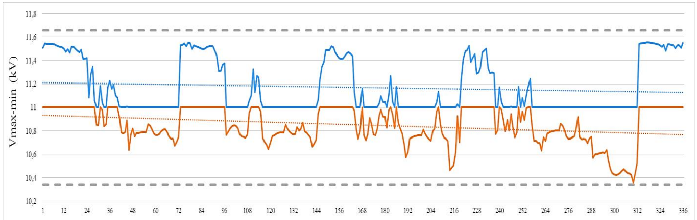
Σχήμα 6.30: Προφίλ Τάσεων (OPF Ανάλυση) για το δίκτυο των 34 ζυγών.
