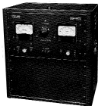
Φωτογραφία 1. Τροφοδοτικό λυχνιών κενού
