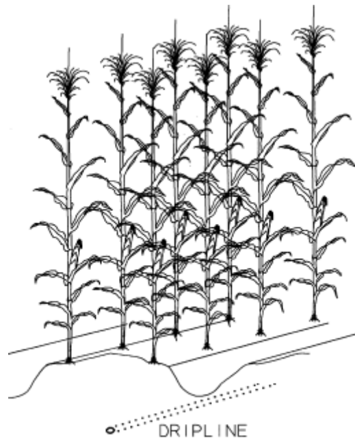
Σχήμα 5.3: Εγκατάσταση δικτύου υπόγειας στάγδην άρδευσης
