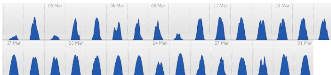
Εικόνα 5-16 Παραγωγή φ/β σταθμού 10kW, Μαρ 2014
