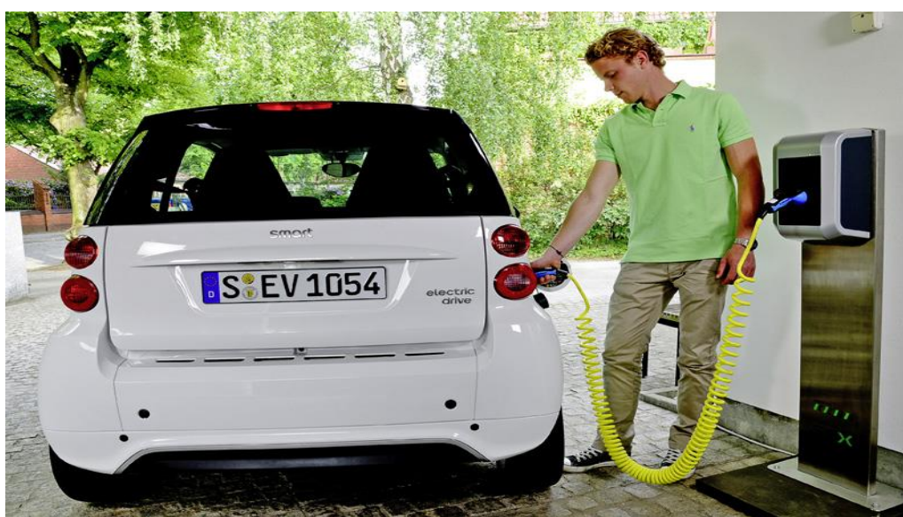
Σχήμα 1.8: Ηλεκτρικό Smart Fortwo κατά τη φόρτισή του
