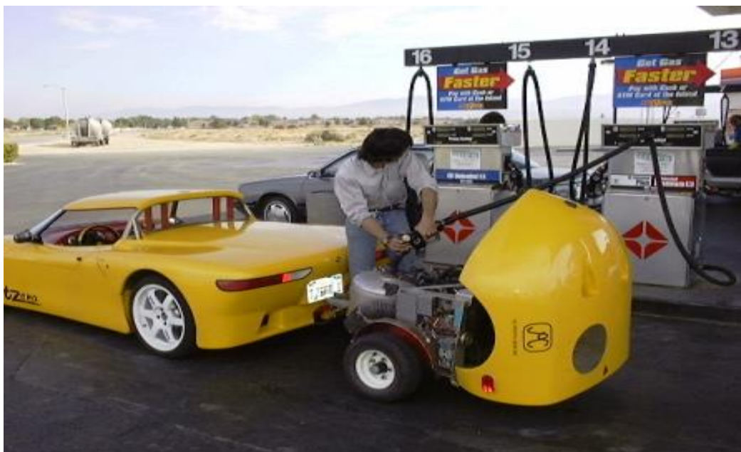
Σχήμα 1.10: Ηλεκτρικό όχημα με μονάδα επέκτασης αυτονομίας (Acr Tzero)
