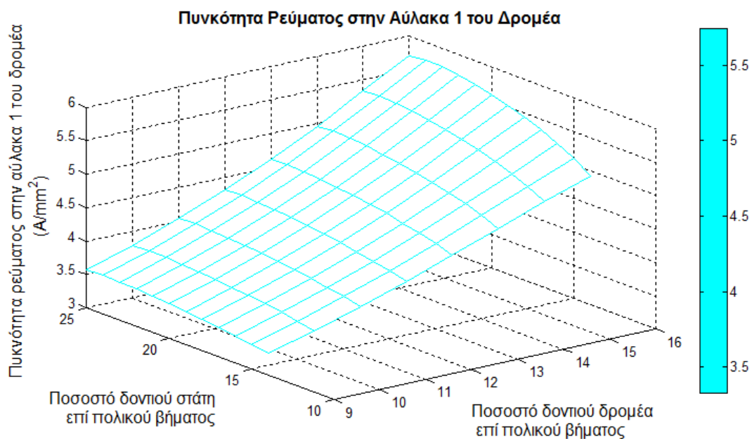
Διάγραμμα 5.32 Πυκνότητα ρεύματος στην αύλακα 1 του δρομέα ως συνάρτηση του ποσοστού πλάτους δοντιού στάτη και δρομέα επί του πολικού βήματος
