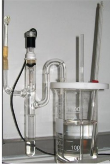
Εικόνα 6.2: Το ηλεκτρολυτικό κελί με το καπάκι από τεφλόν στο οποίο στηρίζονται το υδραργυρικό θερμόμετρο, το ηλεκτρόδιο αναφοράς και ο σωλήνας παροχής
