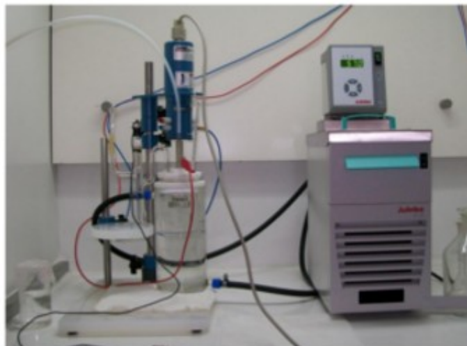
Εικόνα 6.17: Φωτογραφία της ηλεκτρολυτικής διάταξης. Ρότορας και το θερμαινόμενο δοχείο στο οποίο τοποθετείται το ηλεκτρολυτικό κελί (αριστερά). Κυκλοφορητής (δεξιά)
