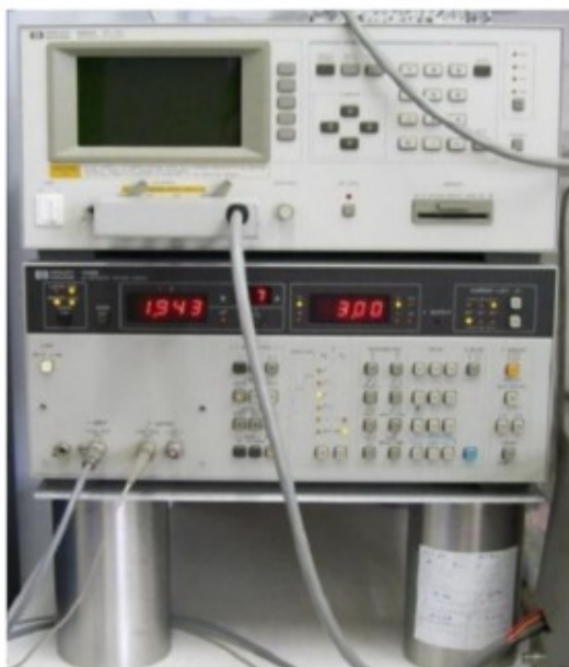
Εικόνα 6.11: Συσκευή pA meter/DC voltage source (HEWLETT PACKARD 4140B)
