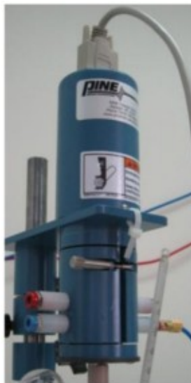
Εικόνα 6.8: Ο ρότορας και οι υποδοχές των καλωδίων για τα ηλεκτρόδια εργασίας
