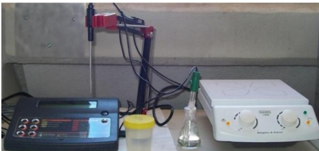
Εικόνα 6.15: Διάταξη μέτρησης του pH και μαγνητικής ανάδευσης
