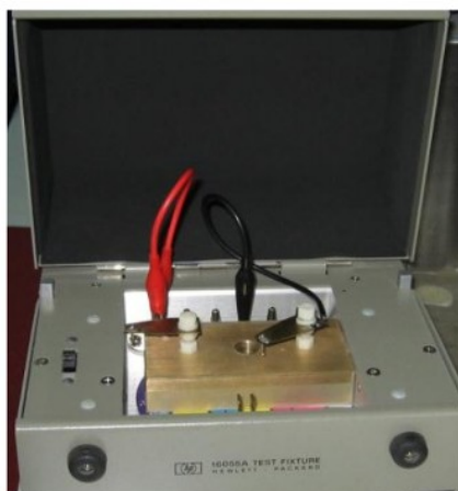
Εικόνα 6.10: Εσωτερικό του κλωβού Faraday που χρησιμοποιήθηκε για τις μετρήσεις
