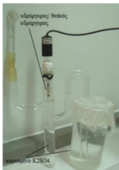
Εικόνα 6.5: Ηλεκτρόδιο αναφοράς. Το ηλεκτρόδιο αναφοράς φυλάσσεται σε κορεσμένο διάλυμα θειικού καλίου
