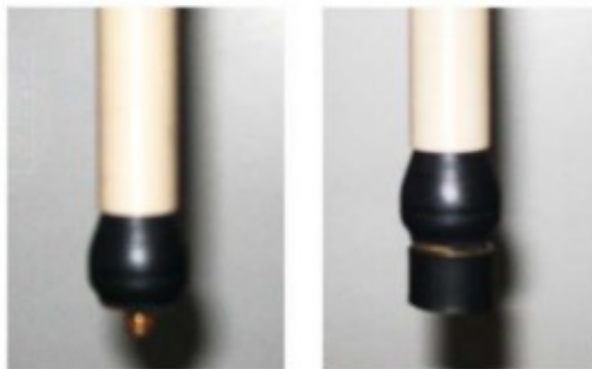
Εικόνα 6.3: Ηλεκτρόδιο εργασίας χωρίς δοκίμιο (αριστερά), όπου φαίνεται η υποδοχή του δοκίμιου. Ηλεκτρόδιο εργασίας με προσαρτημένο το δοκίμιο (δεξιά)
