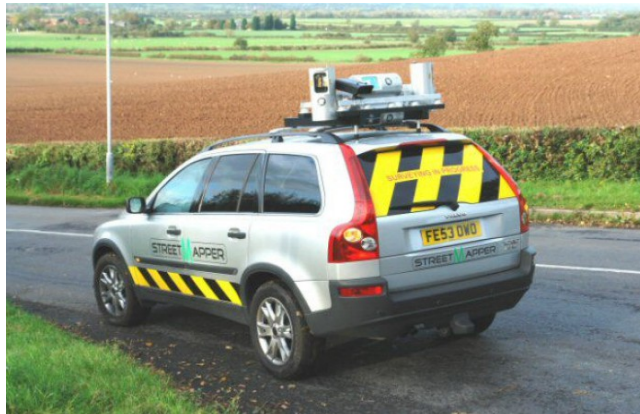
Σχήμα 3.2: Κινητός σαρωτής ενσωματωμένος σε όχημα [13]
