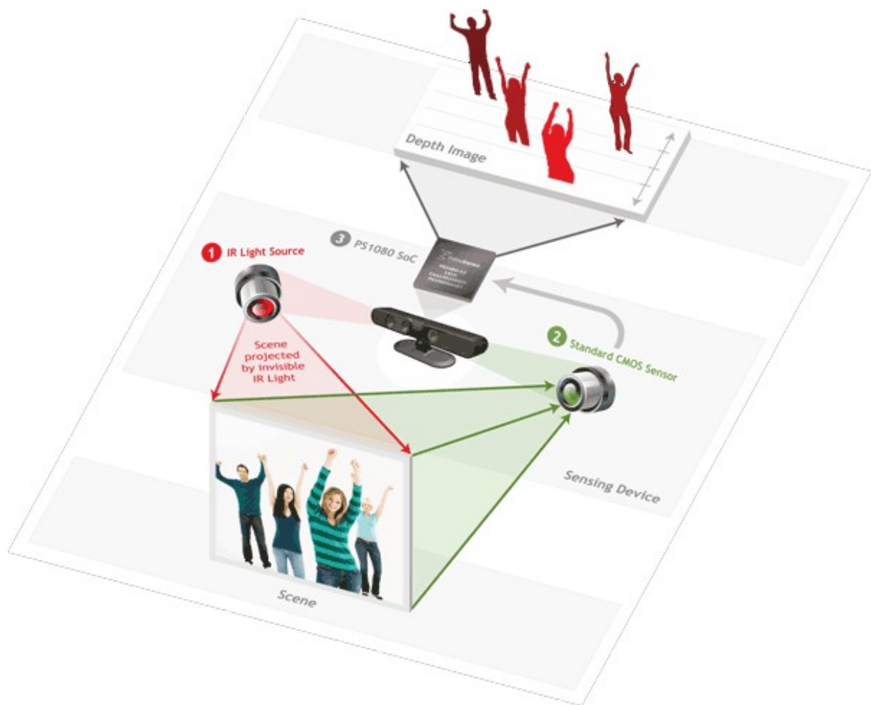
Σχήμα 3.9: Σχηματική αναπαράσταση της λειτουργίας του αισθητήρα Kinect
