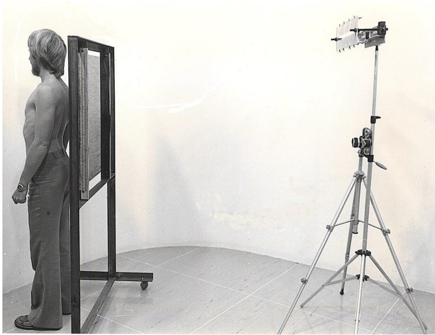
Σχήμα 2.10: Διάταξη για την εξέταση με χρήση μοτίβων Moiré
