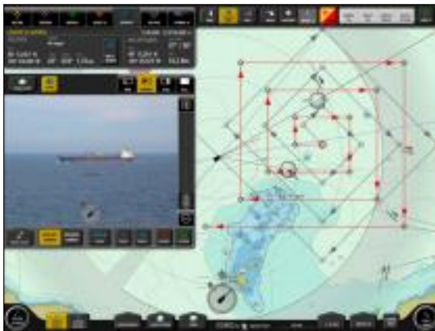
Σχήμα 3.22 : Βίντεο πραγματικού χρόνου με ταυτόχρονη απεικόνιση θέσης και ταχύτητας
