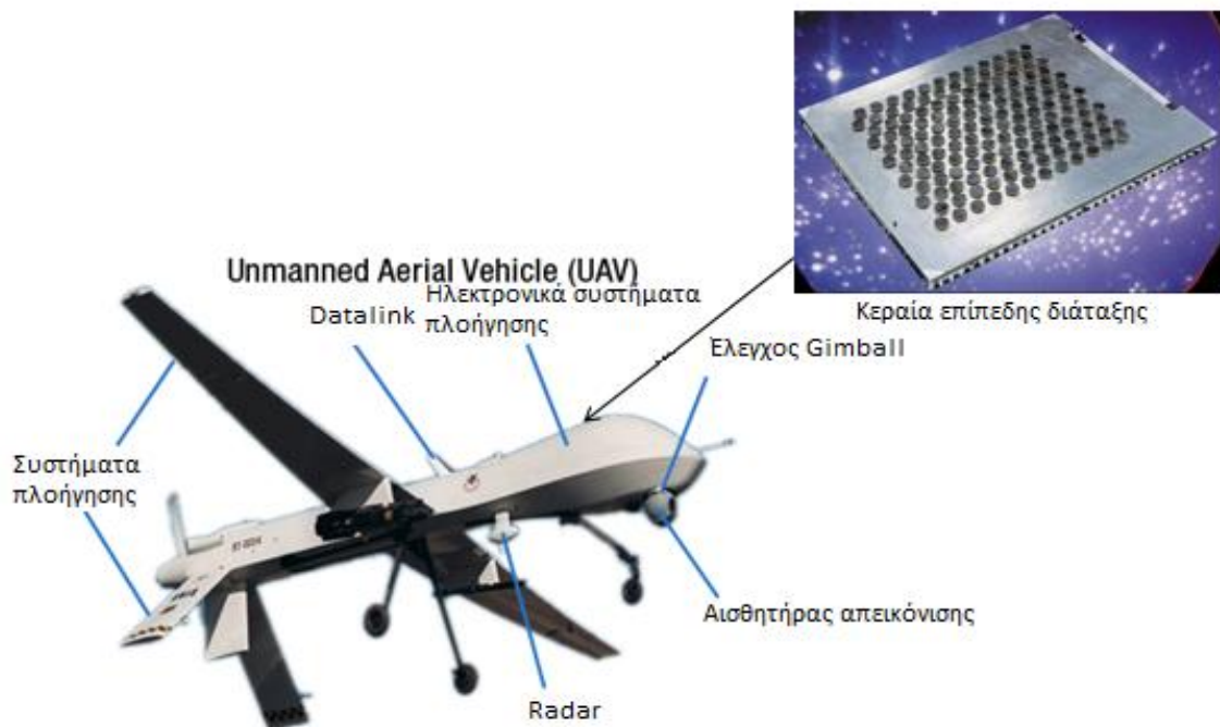
Σχήμα 3.11 : Δομή και κύρια χαρακτηριστικά ενός UAV
