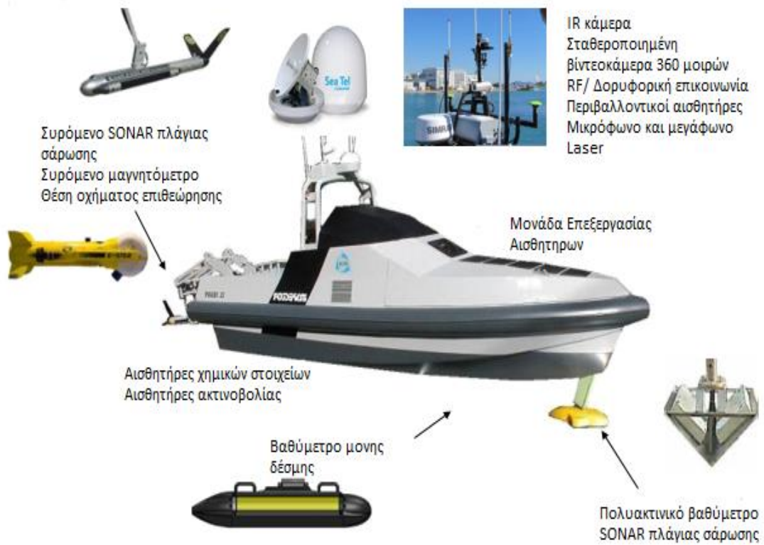
Σχήμα 3.10 : Δομή και κύρια χαρακτηριστικά ενός USV
