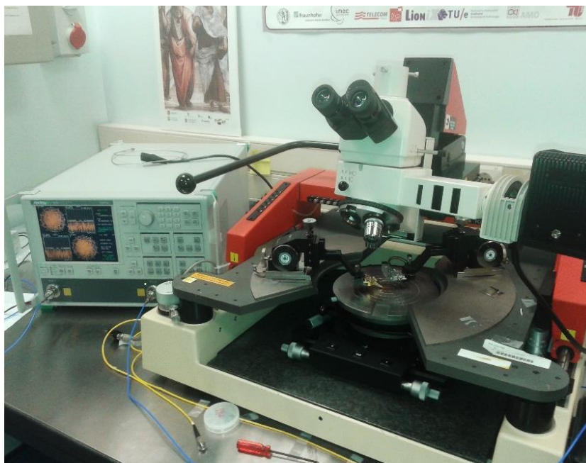
Σχήμα 5-2: Η διάταξη της πλατφόρμας μετρήσεων που αναπτύχθηκε. Απεικονίζεται το probe station (δεξιά) καθώς και ο Διανυσματικός Αναλυτής Δικτύου VNA (αριστερά)
