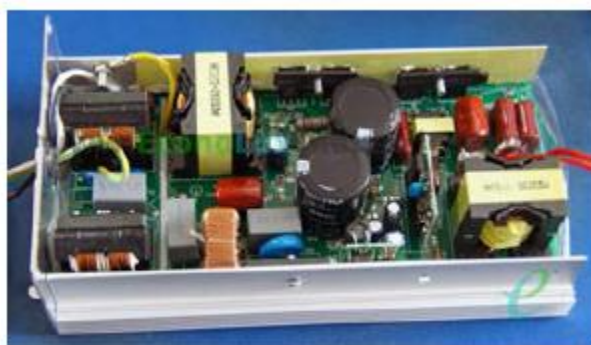
Εικόνα 2.1.1: Σύστημα Τροφοδοσίας Λαμπτήρα Μαγνητικής Επαγωγής [1]
