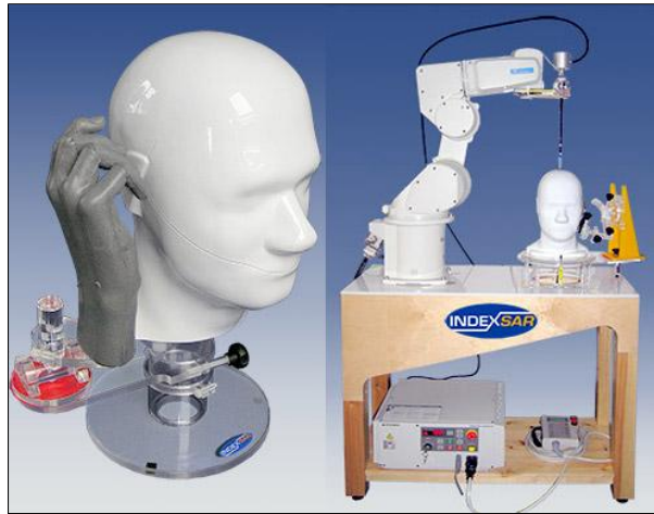
Σχ. 2.15 Φυσικό μοντέλο ανθρώπινης κεφαλής για εργαστηριακές δοκιμές [61].
