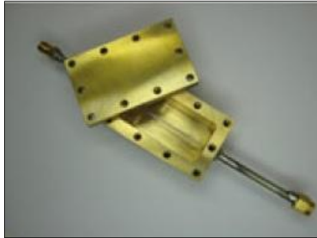
Σχ. 3.2 Ομοαξονικό δοχείο για μετρήσεις μιγαδικής επιτρεπτότητας σε υγρά υλικά.
