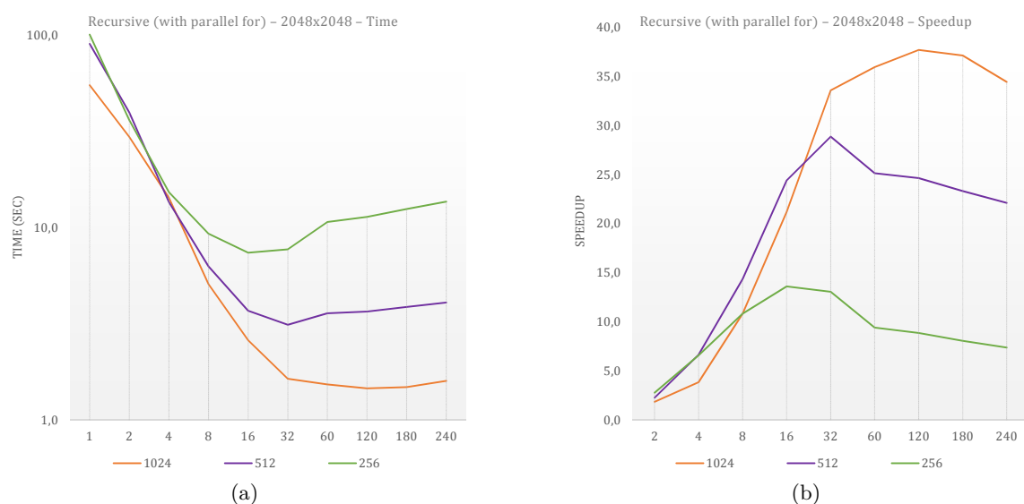
Σχ. 4.46: Αποτελέσματα μετρήσεων αναδρομικής υλοποίησης στον Xeon Phi για γράφο μεγέθους 2048 \times 2048
