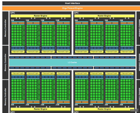
Σχ. 2.11: Block διάγραμμα του chip της αρχιτεκτονικής Fermi
