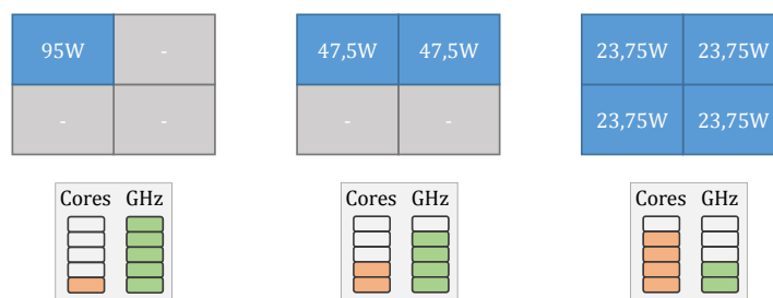
Σχ. 1.10: Σχηματική αναπαράσταση της λειτουργίας του Turbo Boost σε έναν τετραπύρηνο επεξεργαστή με 95W ανώτατη προδιαγραφή κατανάλωσης (TDP)
