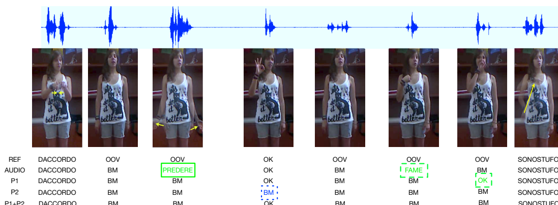
Σχήμα 5.2: Παράδειγμα αναγνώρισης για μία ακολουθία λέξεων-χειρονομιών. Στην κορυφή τοποθετείται η οπτικοποίηση του σήματος ήχου για το συγκεκριμένο απόσπασμα και στη συνέχεια η οπτική πληροφορία, μέσω μιας σειράς στιγμιότυπων του καναλιού RGB. Ακολουθεί η πραγματική ακολουθία λέξεων-χειρονομιών για το παράδειγμα (REF), τα αποτελέσματα αναγνώρισης για την τροπικότητα του ήχου (AUDIO), και για τα τρία σχήματα σύμμειξης (P1, P2, P1+P2). Το background μοντέλο bm μοντελοποιεί τις λέξεις εκτός λεξιλογίου (OOV).
