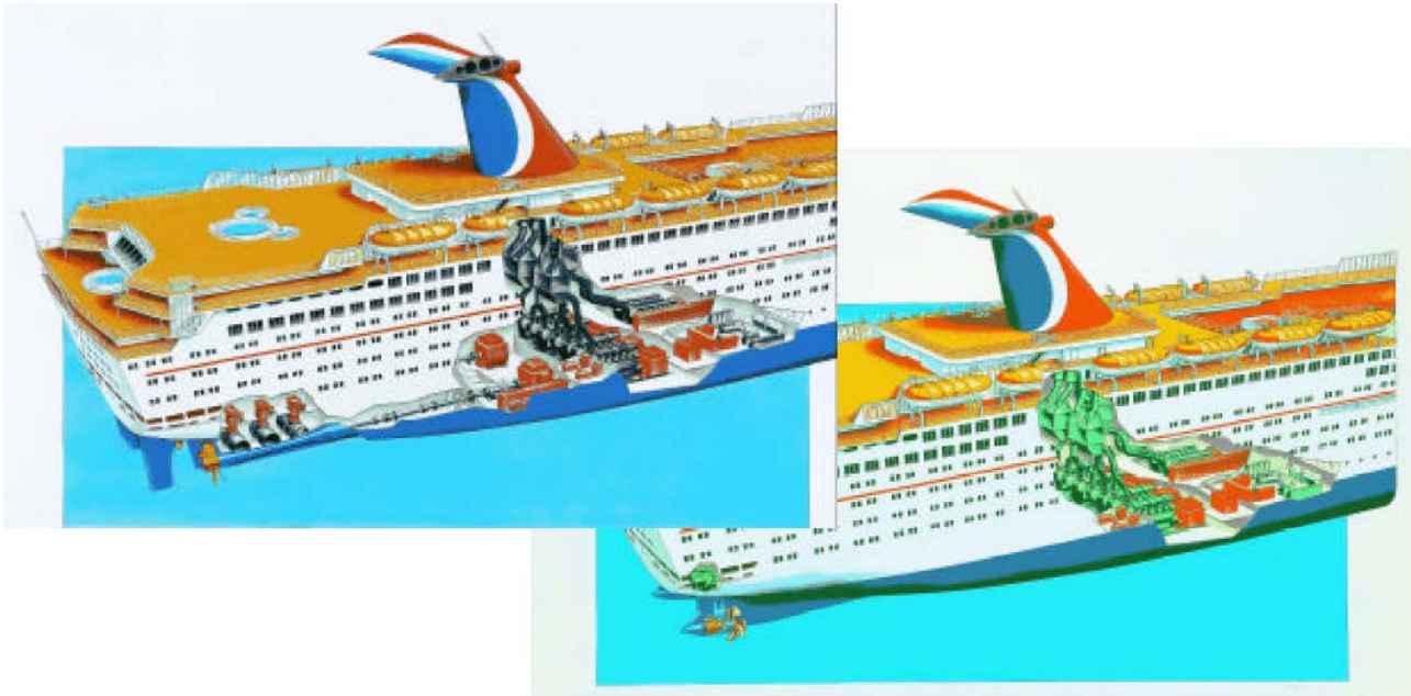
Σχήμα 3.4: Το κρουαζιερόπλοιο “M/S Elation” (κάτω δεξιά) εξοπλισμένο με Azipod έχει περισσότερο ελεύθερο χώρο σε σχέση με άλλα αντίστοιχα πλοία, ο οποίος μπορεί να χρησιμοποιηθεί για άλλους σκοπούς, όπως π.χ. επεξεργασία λυμάτων.
