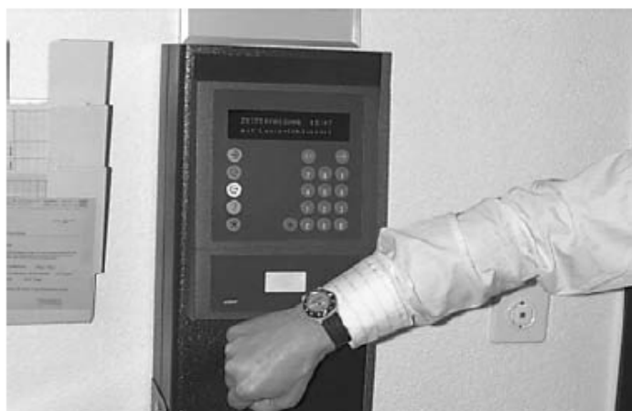
Σχήμα 2.23: Έλεγχος πρόσβασης με χρήση της τεχνολογίας RFID
