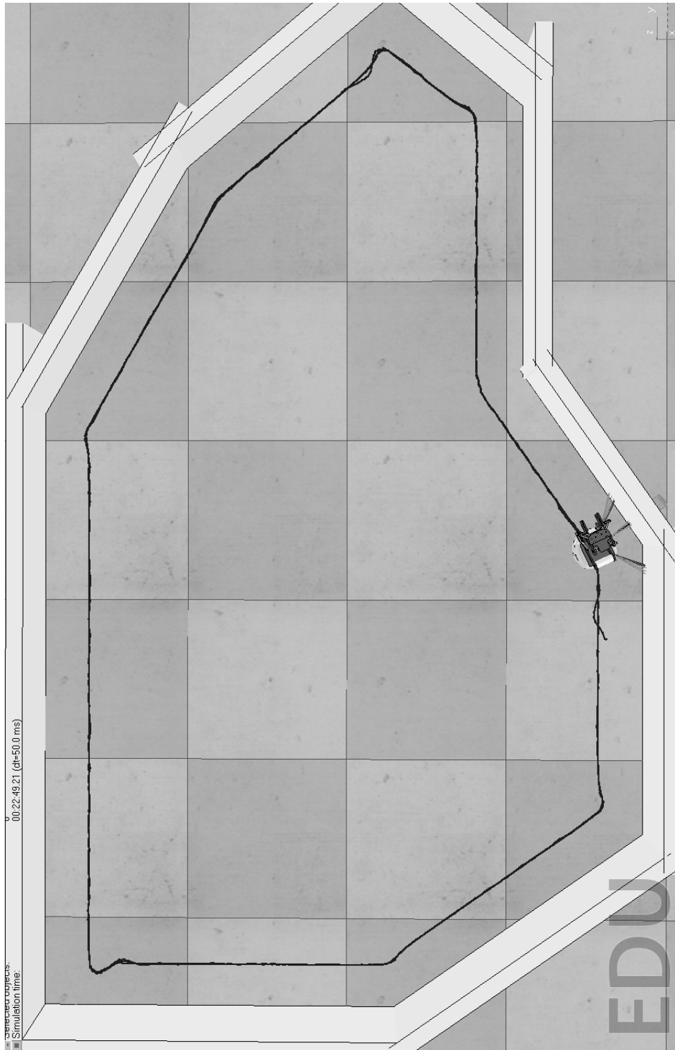
Σχήμα 10.18: Μονοπάτι που ακολούθησε το ρομπότ στον εξομοιωτή κατά την εκτέλεση της αρένας διαφορειακών γωνιών υπό Ασαφή Ενισχυτική Μάθηση, 1000 εποχές
