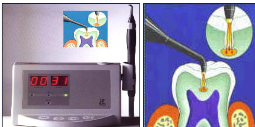
Σχήμα 3.6: α) Η συσκευή Kavo Diagnodent β) Η συσκευή Diagnodent προσφέρει το πλεονέκτημα της μέτρησης του φθορισμού σε περιοχές σχισμών, στις οποίες το laser αντανακλάται δια μέσου πολύ στενών διόδων [42].
