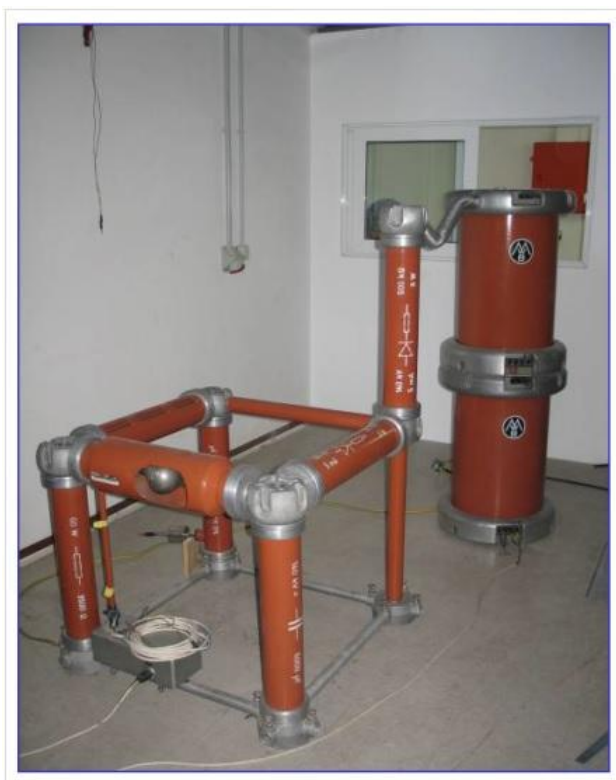
Εικόνα 3.7 Λυόμενη μονοβάθμια κρουστική γεννήτρια
