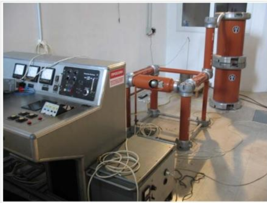
Εικόνα 3.6: Πειραματική διάταξη παραγωγής κυματομορφής 1,2/50 \mu s
