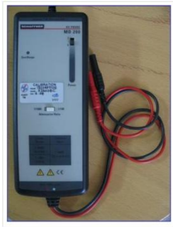
Εικόνα 3.10: Διαφορικός καταμεριστής MD200 Schaffner
