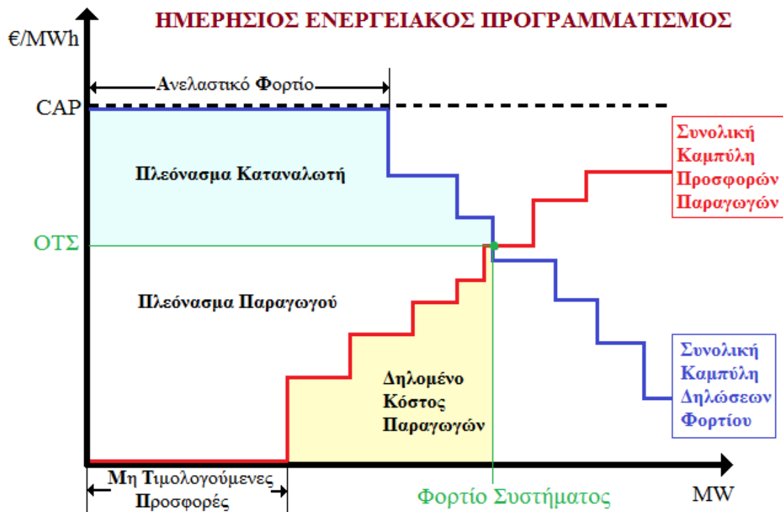
Εικόνα 1.1.1: Συνολικές καμπύλες προσφοράς-ζήτησης και καθορισμός της Οριακής Τιμής Συστήματος [3]
