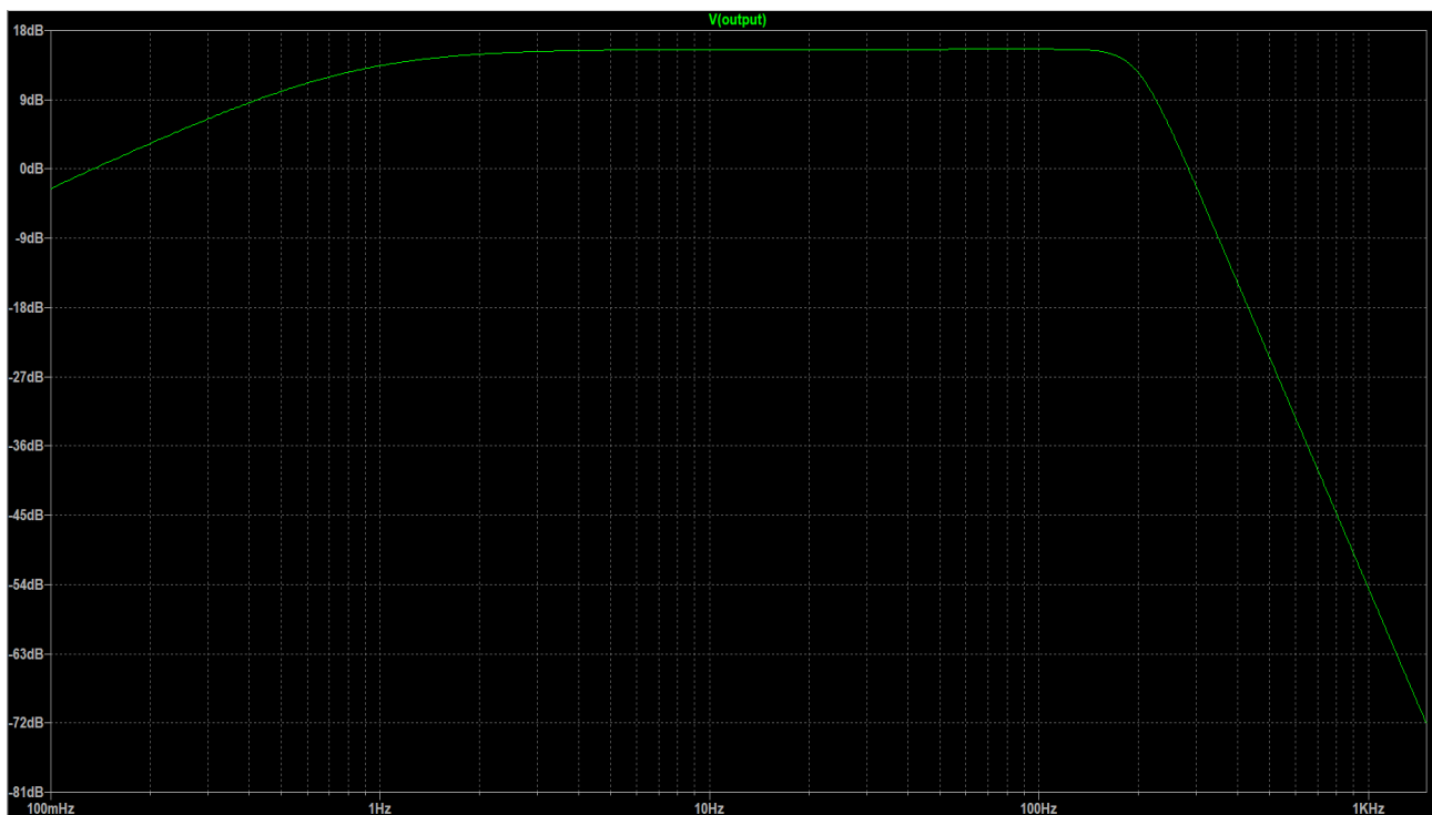
Σχήμα 3.20 Συνάρτηση κέρδους κυκλώματος αναφοράς
