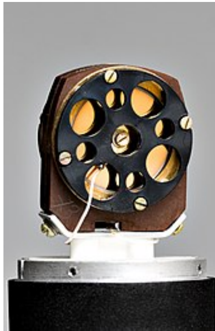
Σχήμα 3.2 Εσωτερική Μορφή ενός Μικρόφωνου Πυκνωτή 14
