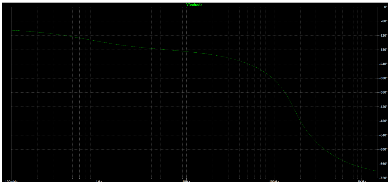
Σχήμα 3.14 Διάγραμμα Bode – Συνάρτηση Φάσης
