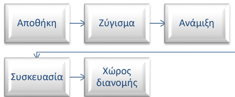
Σχήμα 3.3 Ροή προϊόντος στη γραμμή παραγωγής
