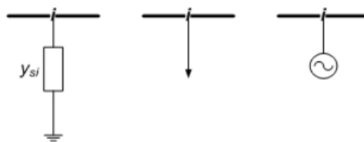
Σχήμα 3.4: φορτίο σταθερής αγωγιμότητας, σταθερής ισχύος και γεννήτριας
