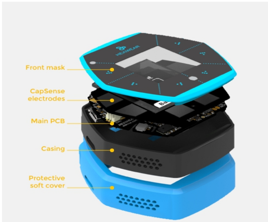
Εικόνα 3.7 : Δομή του Hexiwear
