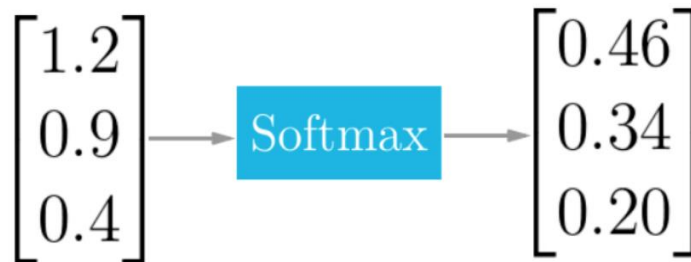
Σχήμα 2.5 Παράδειγμα της συνάρτησης Softmax
