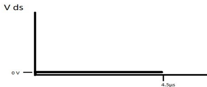
Εικόνα 71. Τάση που αναπτύχθηκε στα άκρα του MOSFET κατά τη φάση 1
