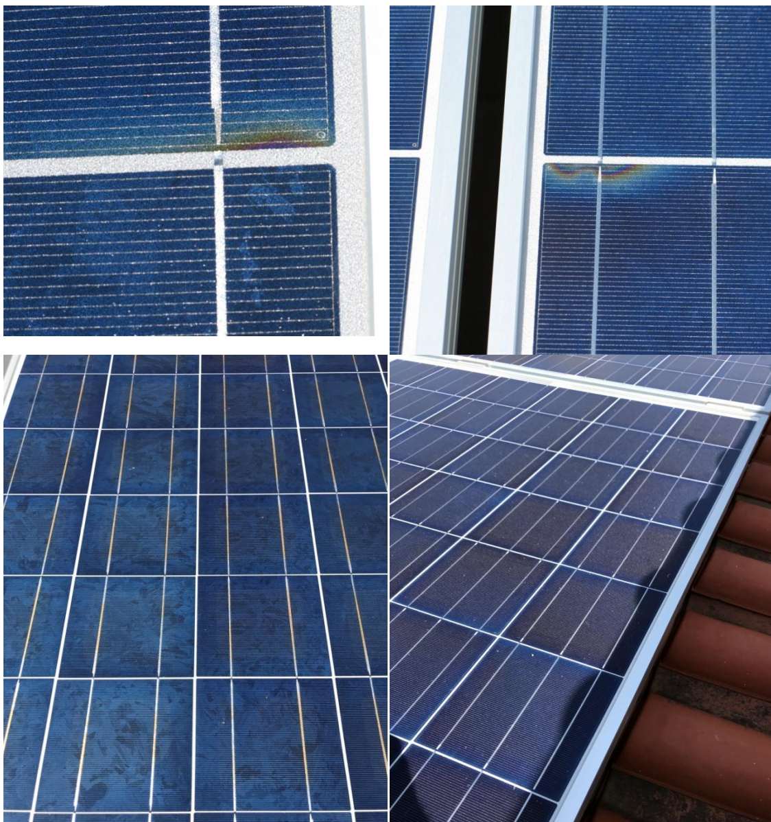
Φωτογραφία 6.27: Υπερθερμάνσεις φ/β κυψελών και hot spots
