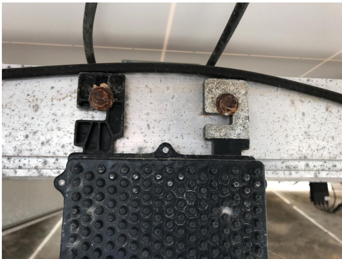
Φωτογραφία 6.4 :Οξειδωμένη βάση στήριξης αλουμινίου.
