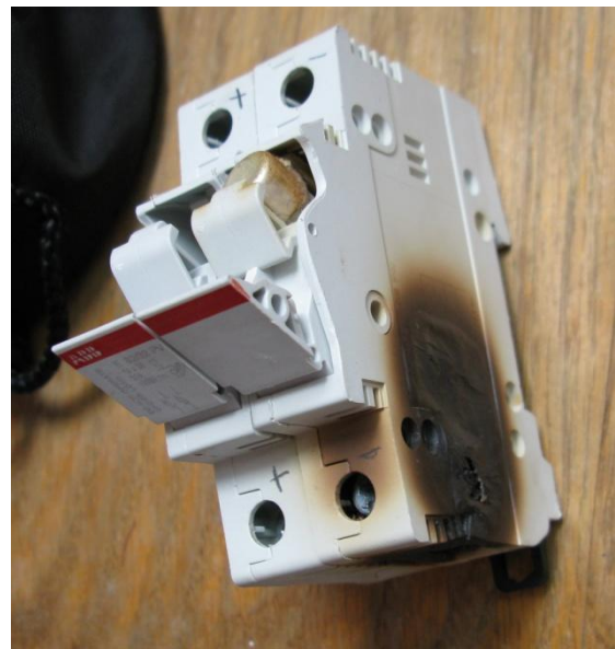
Φωτογραφία 6.10 : Κακές συσφίξεις καλωδίων οι οποίες οδήγησαν σε καταστροφή εξαρτημάτων και βλάβες.
