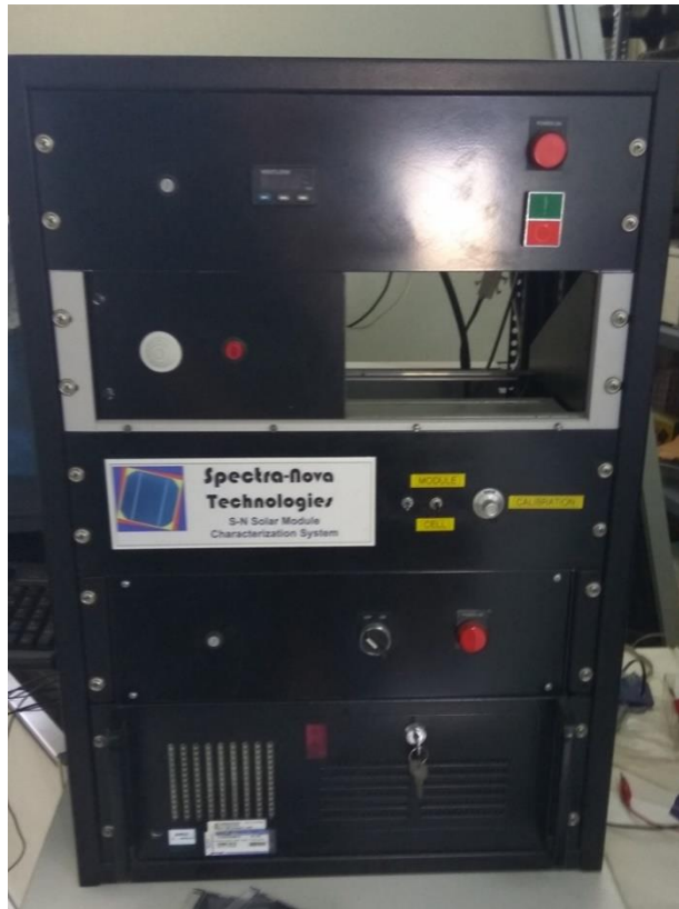
Εικόνα 5.2 Μηχάνημα παραγωγής I-V χαρακτηριστικής
