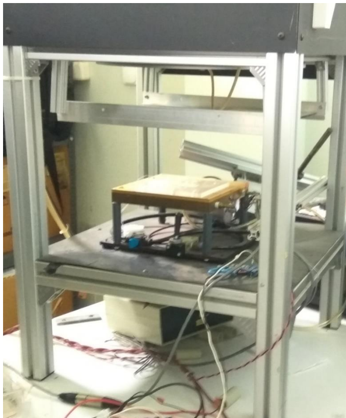
Εικόνα 5.1: Επιφάνεια μέτρησης του κελιού και κουβούκλιο που εσωκλείει την λάμπα παραγωγής της τεχνητής δέσμης.
