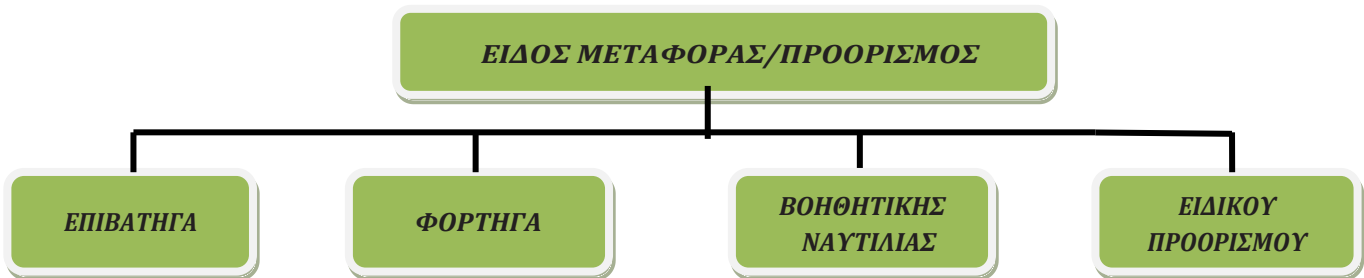
Σχήμα 3.1 Τύποι πλοίων ανάλογα με το είδος μεταφοράς και τον προορισμό
