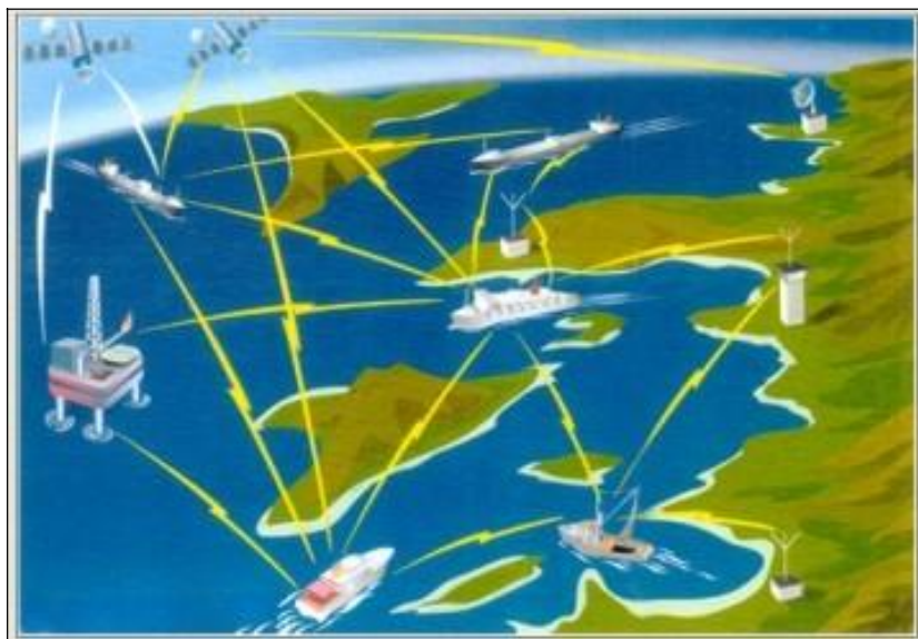
Σχήμα 5.6. Διάχυση πληροφοριών AIS τόσο για την ασφάλεια της ναυσιπλοΐας, όσο και για τον έλεγχο της ναυτιλιακής κίνησης από συστήματα επιτήρησης.
