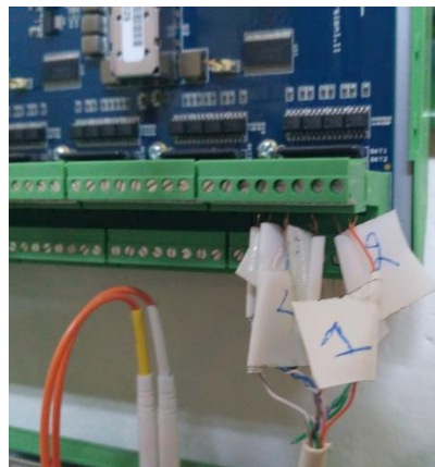
Σχήμα 7.6: Κάρτα GTDI για την παροχή εισαγωγή των παλμών από τον DSP.
