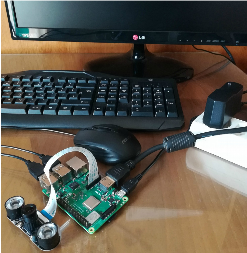
Σχήμα 38: Συνδεσμολογία του Raspberry με την κάμερα.
