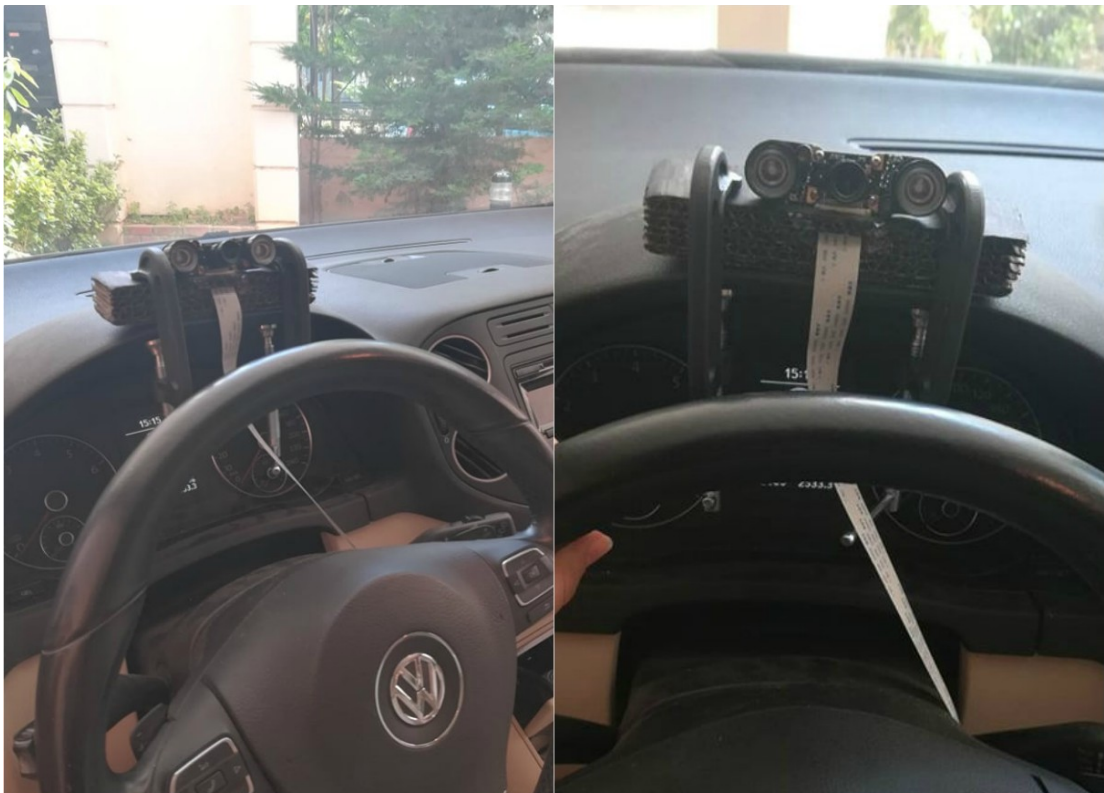
Σχήμα 57: Η ενσωμάτωση της κάμερας στο αυτοκίνητο μαζί με τη βάση της.
