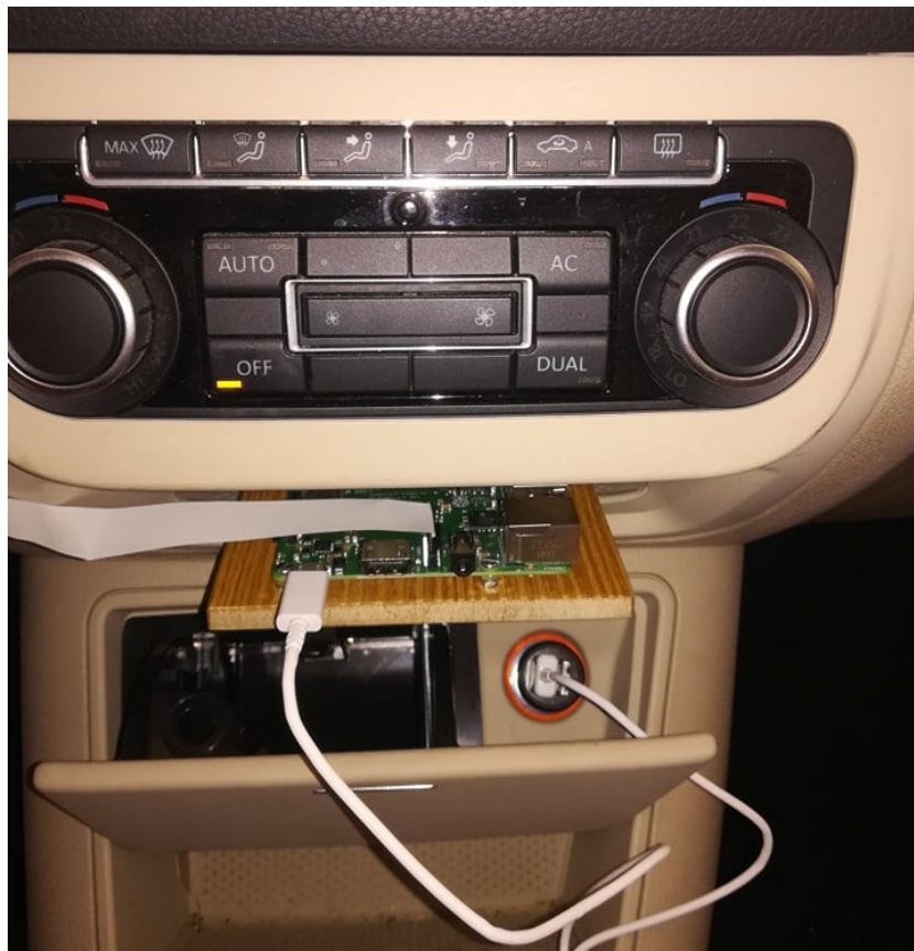
Σχήμα 64: Η σύνδεση του Raspberry με το αμάξι μέσω της θύρας του αναπτήρα.
