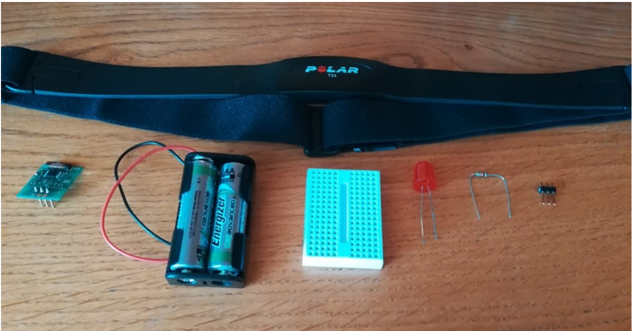
Σχήμα 50: Όλα τα στοιχεία του αισθητήρα Polar T31.
