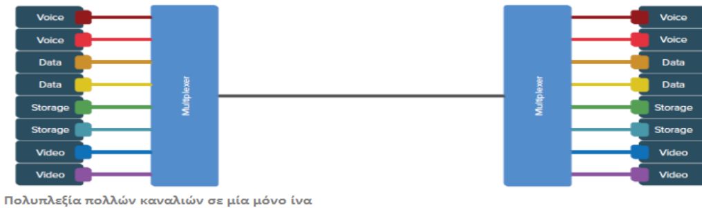
Εικόνα 1.8: Αναπαράσταση Wavelength Division Multiplexing (WDM)
