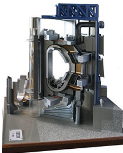
Εικόνα 1.3.2 - Απεικόνιση τομής του τόρου του ITER
