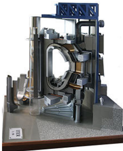
Σχήμα 1.10: Απεικόνιση τομής του τόρου του ITER
