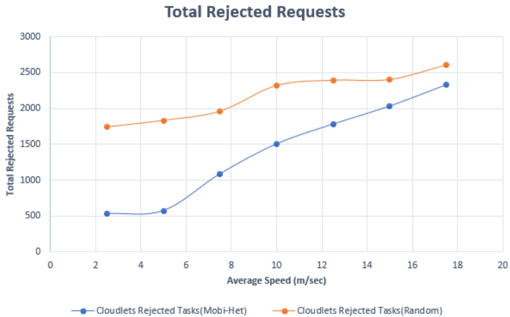
Σχήμα 5.19: Συνολικά Απορριφθέντα Αιτήματα Εφαρμογών Σε Συνάρτηση Της Μέσης Ταχύτητας Κινητικότητας Των Κινητών Συσκευών.
