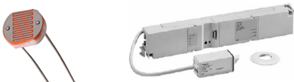
Εικόνα 2.9 α) Φωτοαντιστάτης β) Αισθητήρας φωτισμού της Siemens με επιπρόσθετη υπομονάδα ελέγχου [42, 52]
