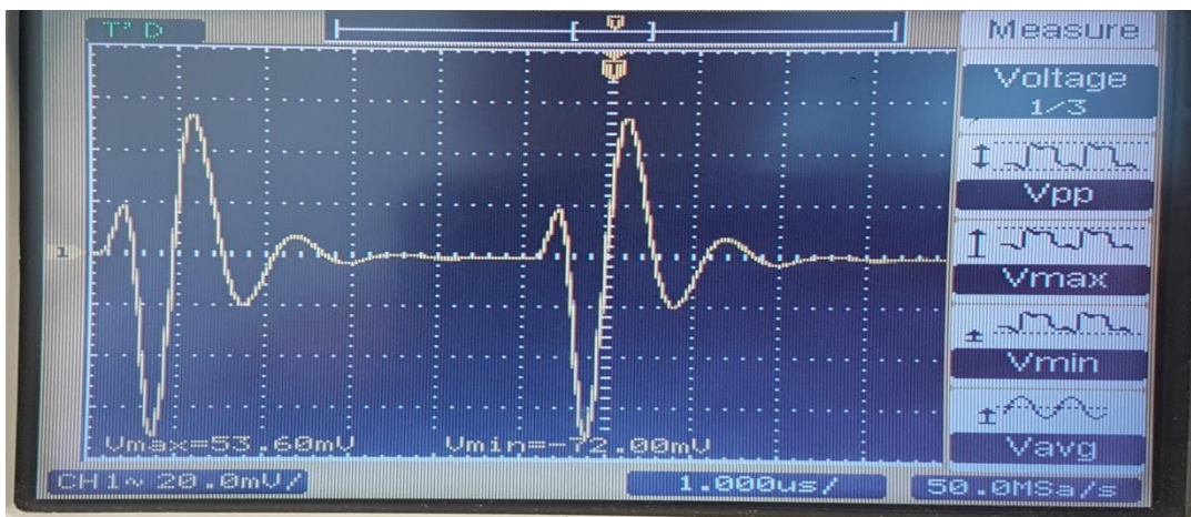
Σχήμα 3.21: Η έξοδος για B_{ext}=0,143\text{mT} για τον παλμό πλάτους 10\text{mA} t_r=33.5\text{ns} w=83\text{ns} f=198.4\text{kHz}
