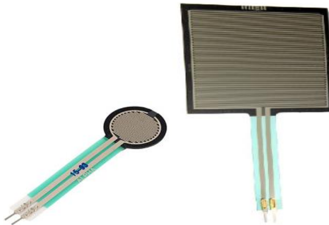
Σχήμα 3.1. Τα δύο μεγέθη αισθητήρων FSR που επελέγησαν στη διάταξη
