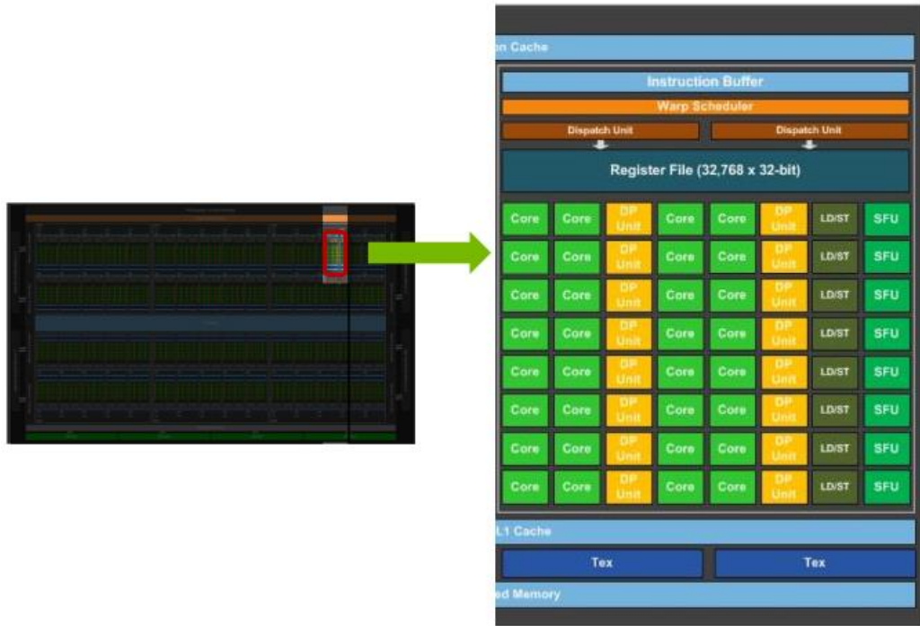
Εικόνα 5: Τμήμα ενός streaming multiprocessor.
