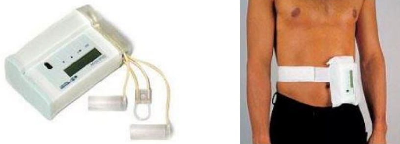
Εικόνα 2.2: Η εξωτερική συσκευή Glucoday, στην οποία εφαρμόζεται ο βιοαισθητήρας και ο τρόπος εφαρμογής της [15]
