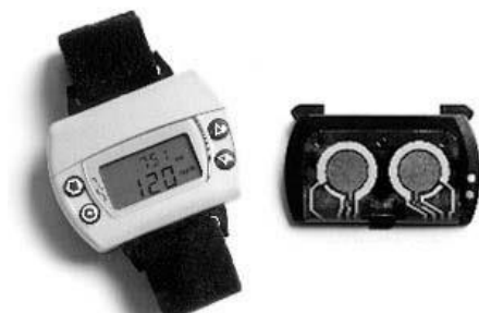
Εικόνα 2.6: Η συσκευή Cygnus Gluco Watch (αριστερά) και ο αισθητήρας γλυκόζης (δεξιά) [19]
