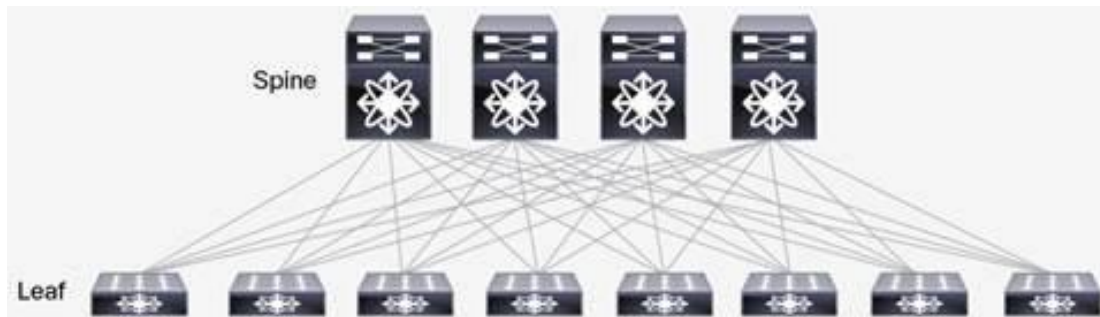
Σχήμα 1.12 – Αρχιτεκτονική leaf-spine δύο επιπέδων
