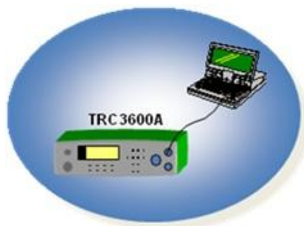
Εικόνα 5.15: Τρόποι λειτουργίας Σ/Α TRC 3600 για μετάδοση δεδομένων
