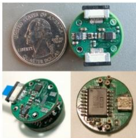
Εικόνα 3.6: Ηλεκτρόδιο χωρίς ηλεκτρική επαφή με το δέρμα [30]
